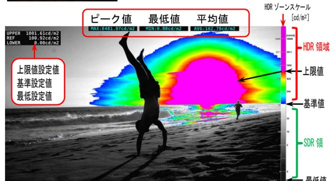
HDR ゾーン表示 : ・SDR 部分はモノクロ、HDR 部分は輝度に応じて着色
