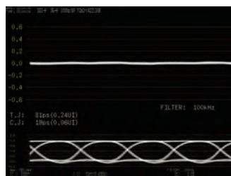
アイパターン表示・ジッタ表示 (LV 5770SER09装着時)
