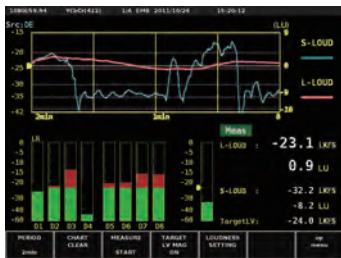
ラウドネス表示 8チャンネルレベルメーター同時表示 (LV 5770SER43装着時)
