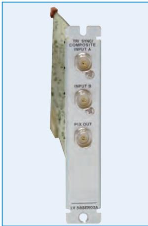
本ユニットはLV 5800Aの入力スロットに挿入するコンポジットビデオ入力ユニットです。アナログのNTSC/PALコンポジットビデオ信号を表示、測定できます。機能として、波形モニター、ベクトルスコープ、簡易ピクチャモニター、外部同期位相差表示などを持っています。(INPUT AとINPUT Bの同時表示はできません)
