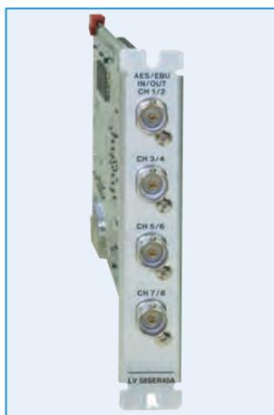
本ユニットは、LV 5800Aの入力スロットに挿入するデジタルオーディオユニットです。LV 5800Aの出力スロットに挿入することでAES/EBU出力ユニットとして動作します。AES/EBU 8系統 16チャンネルのデータについては、リサージュ表示やサウンド表示、メーター表示、信号のステータス表示、チャート表示が可能です。さらにLV 58SER01Aとの組み合わせで、SDI信号から分離したAES/EBU信号を本ユニットで扱うことができます。
