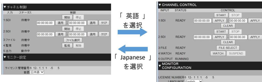
図 4.38 Hybrid QC 制御 GUI 表示言語設定
