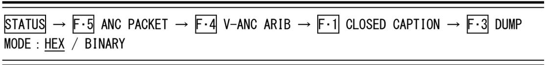
ダンプ画面では、ファンクションダイヤル(F・D)を使ってスクロールさせることでパケット全体を確認できます。また、ファンクションダイヤル(F・D)を押すと、パケット先頭に表示を戻せます。
