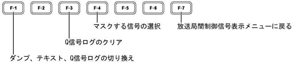
F-4 BIT MASK は、F-1 DISPLAY で「DUMP」以外を選択したときに表示されます。
