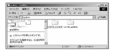
(6) PrintScreen を押すと public フォルダに ScreenCapture されたファイルが出力されます。 出力ファイルが表示されない場合は表示(V)/最新の情報に更新(R)をクリックします。
