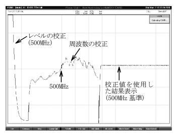
c) Wave画面で、F9(Calibration)を押し、 F5(VSWR)を押すと、約20秒でレベルと周波 数特性の校正が行われ、校正値がバックアッ プメモリーに記憶されます。
