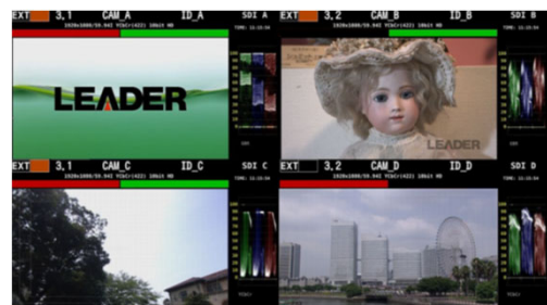
例2，常用界面，图像为主显示波形的4路SDI信号界面。波形可以选择RGB或者Y亮度波形。
