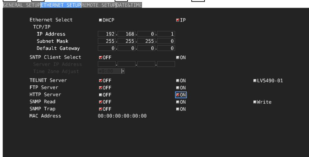
図 20-4 ETHERNET SETUP 画面
