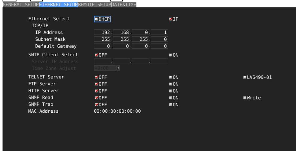
図 7-14 ETHERNET SETUP タブ
