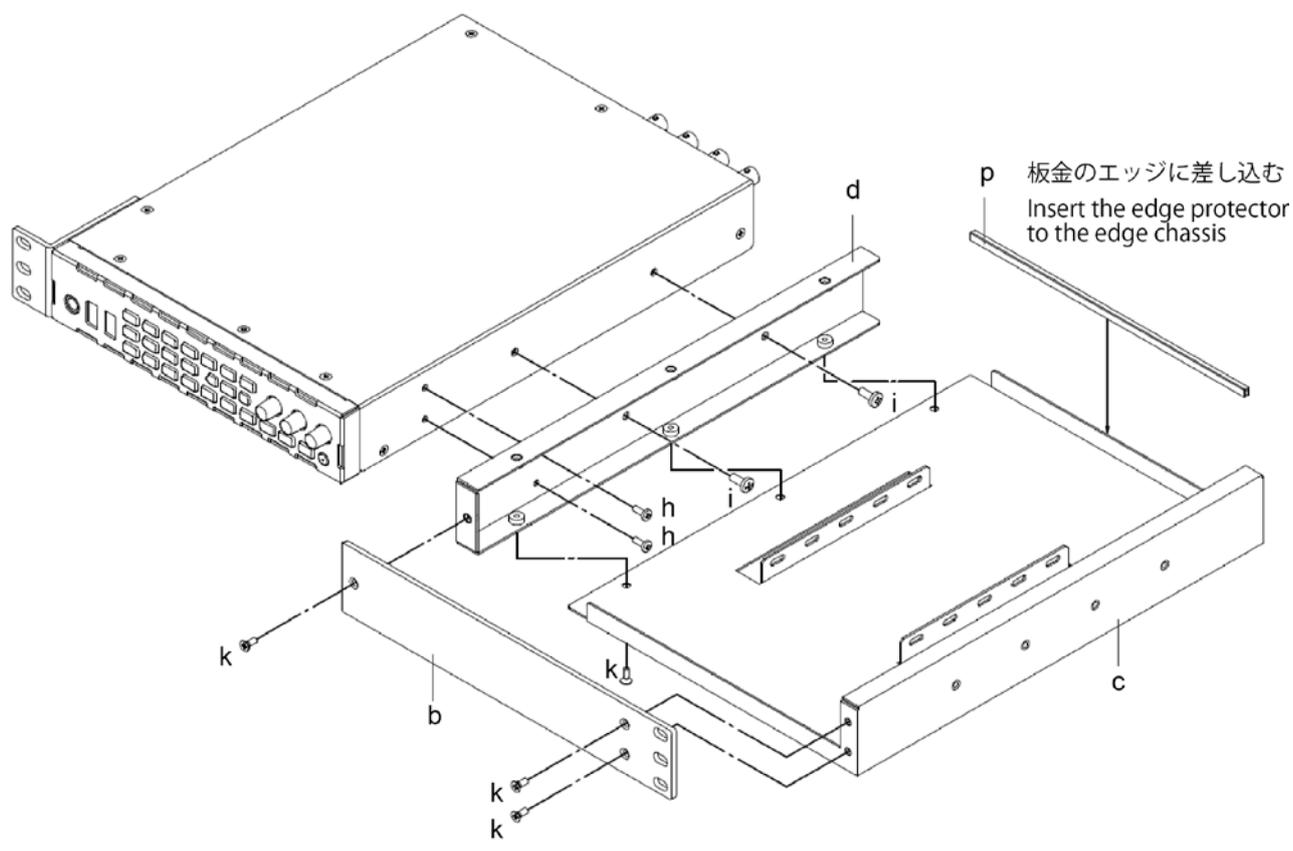
4. シャシ(c)とLV7300の側面にレールサポート(f)とスライドレール(e)を取り付けてから、ラック本体へ固定します。スライドレール(e)の固定位置は、ラック本体の奥行きに合わせてください。Slide Rails (e) must be fixed on the Chassis (c) and on the side of LV7300 and then, they must be fixed to the Rack. The position for fixing a Slide Rail (e) and Rail Support (f) must be decided according to the depth of the Rack.
