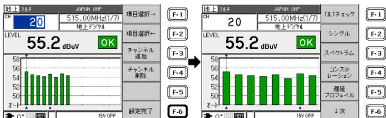
設定したチャンネルテーブルを保存して再び呼び出せるようにするには、メモリーに保存します。
