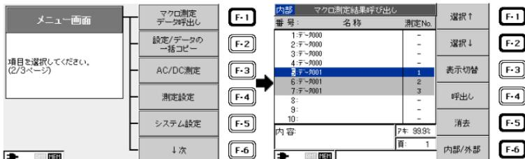
②以降は「6.6.1 チャンネルテーブルの消去」と同様の操作を行います。マクロ測定結果呼び出し画面では、1回のマクロ測定で保存したデータを、グループでグループ表示します。消去を押したときに消去されるデータは、グループ全体のデータではなく、選択したデータのみとなります。
