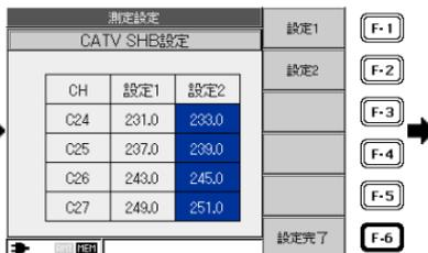
設定したチャンネルテーブルを使用して再び呼び出せるようにするには、メモリに保存します。
