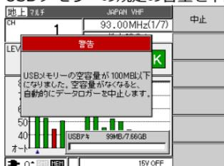
300MBより100MBステップで警告を表示されます。100MB以下は10MBステップで警告を表示されます。キー操作で警告表示は消えます。
