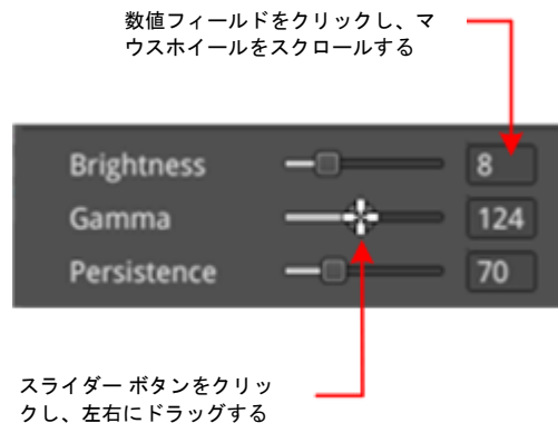
図 2-18 : 「Analyzer - Vectorscope」（アナライザー - ベクトルスコープ）計測器の数値調節 数値は、次のいずれか方法で調節することができます :
