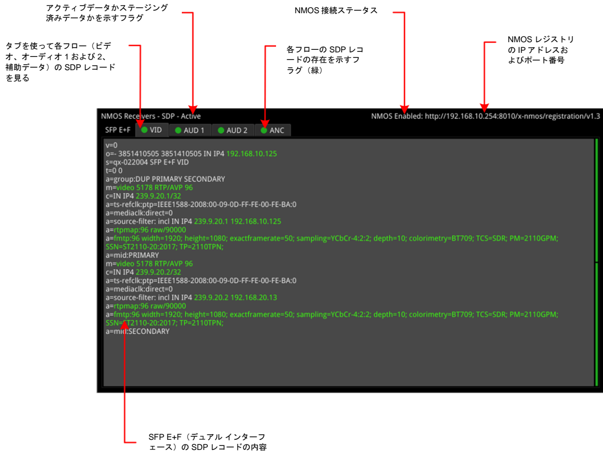
図 4-18 : 「NMOS Receivers - SDP」 (NMOS 受信機 - SDP) 計測器の画面 (デュアルインターフェース、1/4 画面サイズ) (IP 2110 ブートモード)
