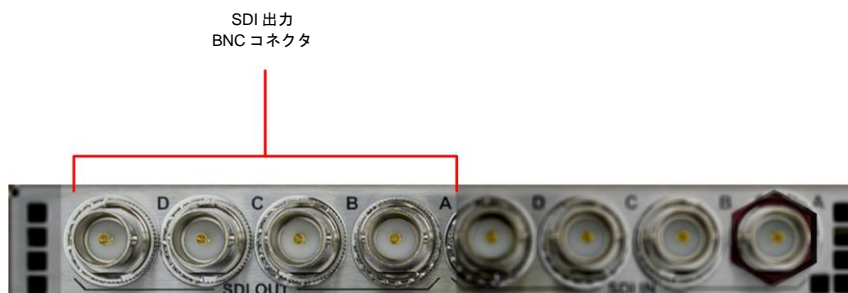
図 5-5 : リアパネルの SDI 入力用 BNC コネクタ
