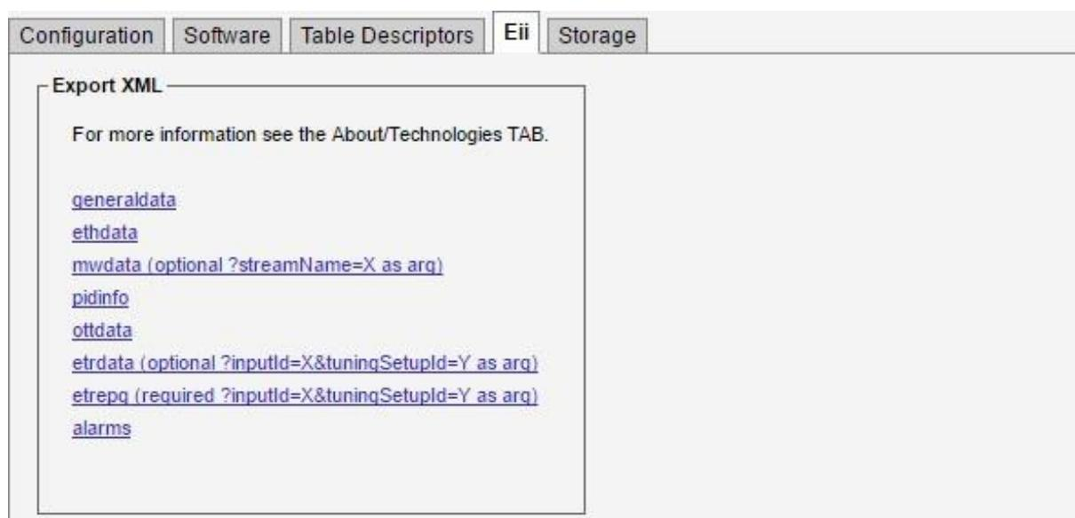
Eii（External Integration Interface：外部装置統合インタフェース）により、Leader の製品をサードパーティのネットワーク管理システムに組み込むことができます。容易に組み込めるように、「Data」（データ）-「Eii」タブで XML ファイルのエクスポートができます。ファイルには、通常の Eii インタフェースでネットワーク管理システムが一般的に必要なデータが含まれています。
