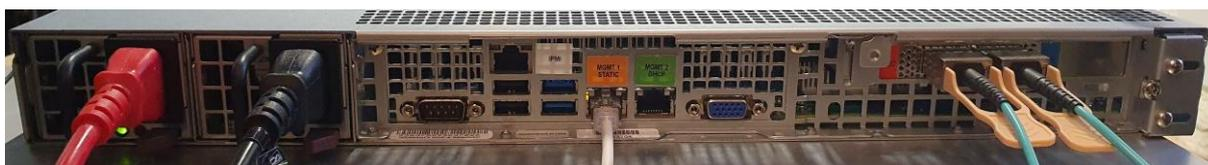
管理用ケーブルを 1 本または 2 本接続します。注：デフォルトの設定で「MGMT 1」（オレンジ）ポートは固定 IP に設定され、「MGMT 2」（グリーン）ポートは DHCP を使用するように設定されています。固定 IP ポートを使用する場合、事前に設定されているアドレスは「10.0.20.101/24」です。
