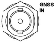
信号を入力すると、「GNSS」の後に「\*」が付きます。また、メッセージが「ADJUST FREQ TO GNSS」>「ADJUST PHASE TO GNSS」>「TRACKING」の順に変わり、基準信号を引き込みます。このままお待ちください。
