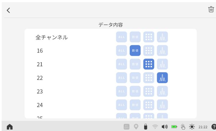
測定データ画面で測定データをタップすると、マルチモードのときは表示エリアの上側に現在のデータ、下側に保存データを並べて表示します。表示形式はバーグラフ固定です。
