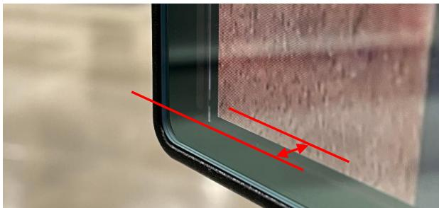
図 4-14 | DUT Surface Depth
