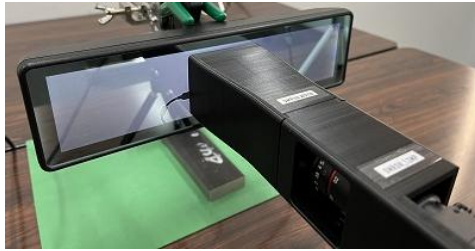
図 5-18 | レンズフードの設置
