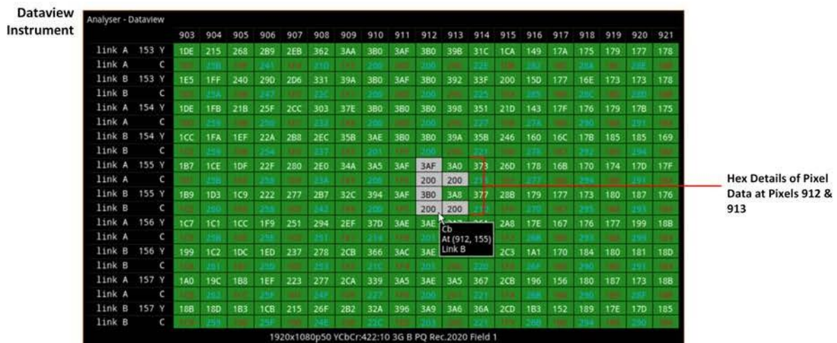
図9-24: 波形計器とデータビュー計器を用いた画像の一部に関する詳細な技術分析
