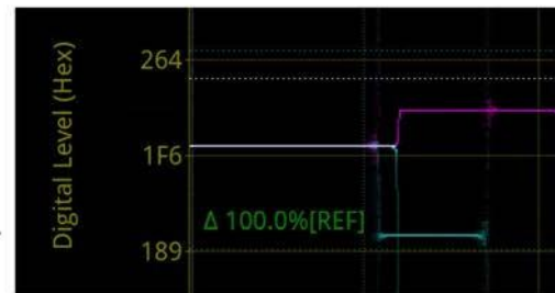
図9-29: 波形連動測定 of 垂直カーソル - 設定%基準値の使用
