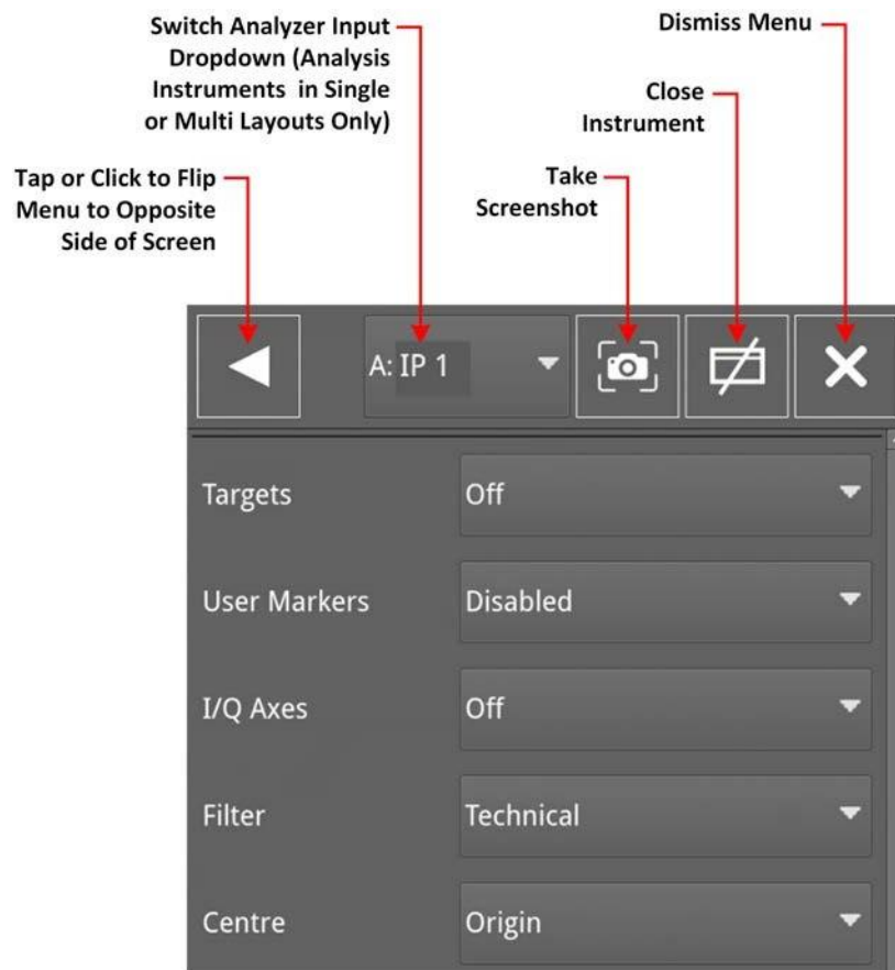
図2-38: メニューツールバーに制御アイコンを表示した機器オプションメニュー
