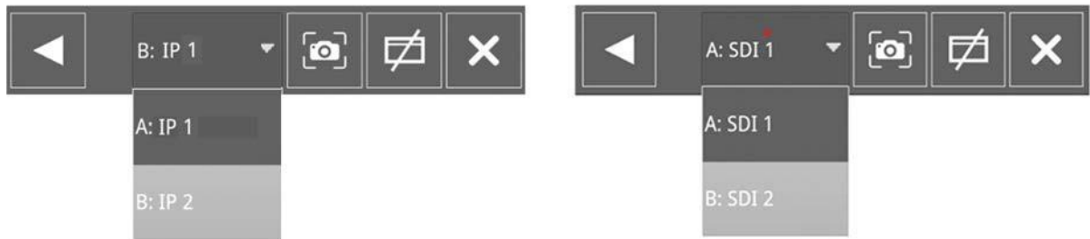
図 2-50: デュアルアナライザのオプションメニュードロップダウンを使用したアナライザの切り替え
