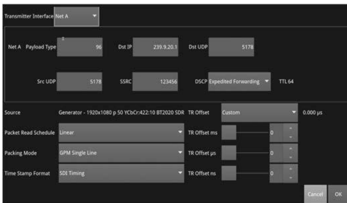
図6-41: 2110送信 - ジェネレータビデオフロー設定
