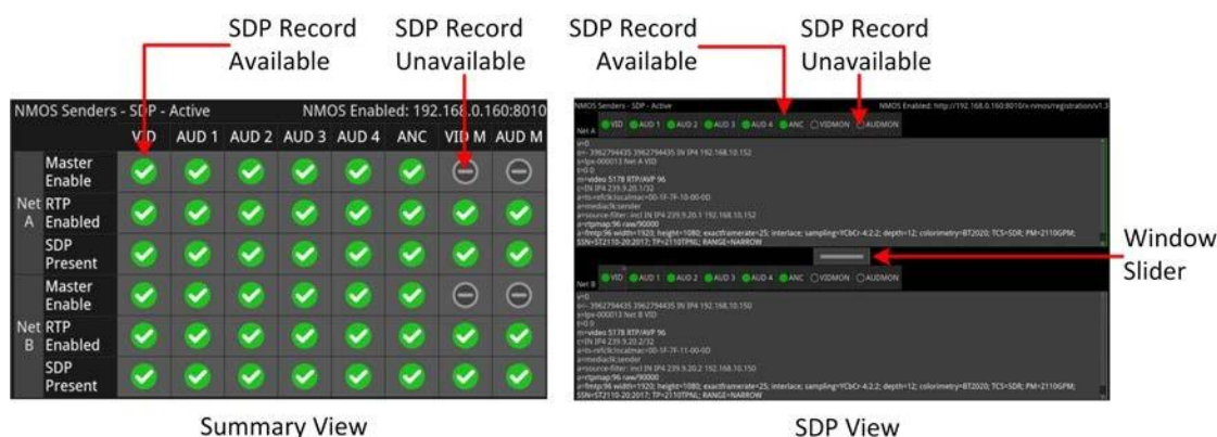
図4-22: NMOS送信機 - SDP計器 (シングルインターフェース) (ST 2110 IP入力)
