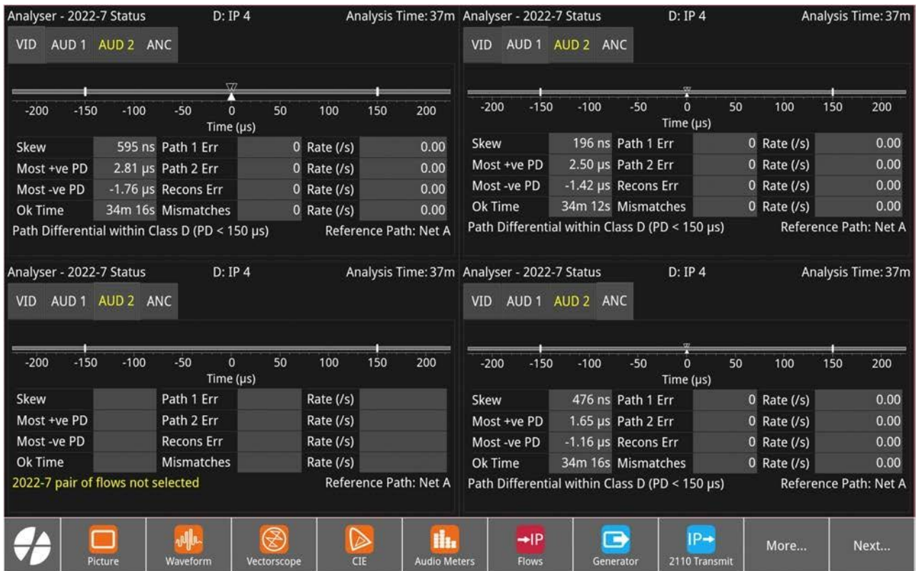
図8-2: アナライザ - 2022-7 ステータスインストルメント (ST 2110 IP Flows)
